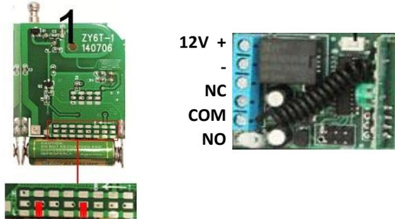
**Método de aprendizaje:** Presione la tecla de aprendizaje en el receptor, presione inmediatamente cualquier botón en el transmisor, después de recibir la señal del receptor, el parpadeo del LED indica un aprendizaje exitoso. Por ejemplo :
